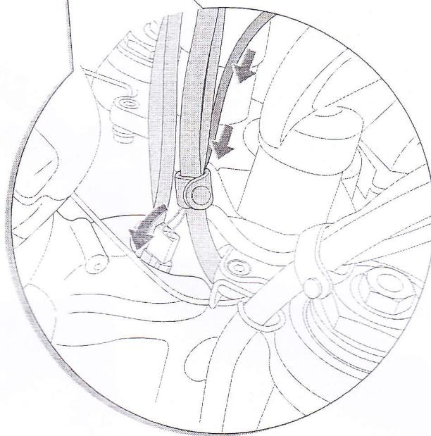
**I** Passare il cavo della manopola (1) nel foro inferiore del supporto cruscotto in corrispondenza del passaggio dei cavi. Recuperare il connettore della manopola dalla parte interna del supporto cruscotto come da figura. Collegare il connettore della manopola con uno dei due connettori (4) dedicati.
